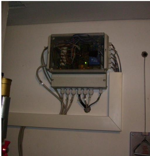
*230V Schaltinterface mit 8 Kanal AD/PWM Interface und PT1000 Präzisionsinterface*
